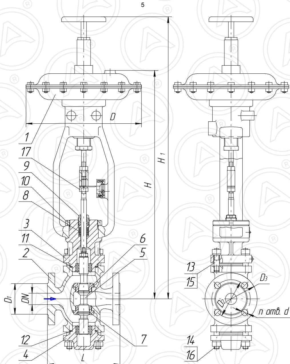
Рисунок 2. Основные узлы и габариты клапана НЗ
