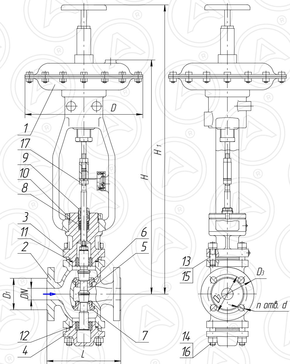
Рисунок 1 Основные узлы и габариты клапана НО
