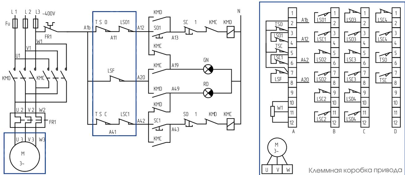
Элементы, обведенные синей рамкой установлены внутри привода. Все что снаружи – пример реализации схемы управления приводом. В клеммной коробке установлены 4 слаботочных клеммника А,В,С,Д, на которые выведены цепи управления, и отдельный силовой клеммник питания двигателя.
