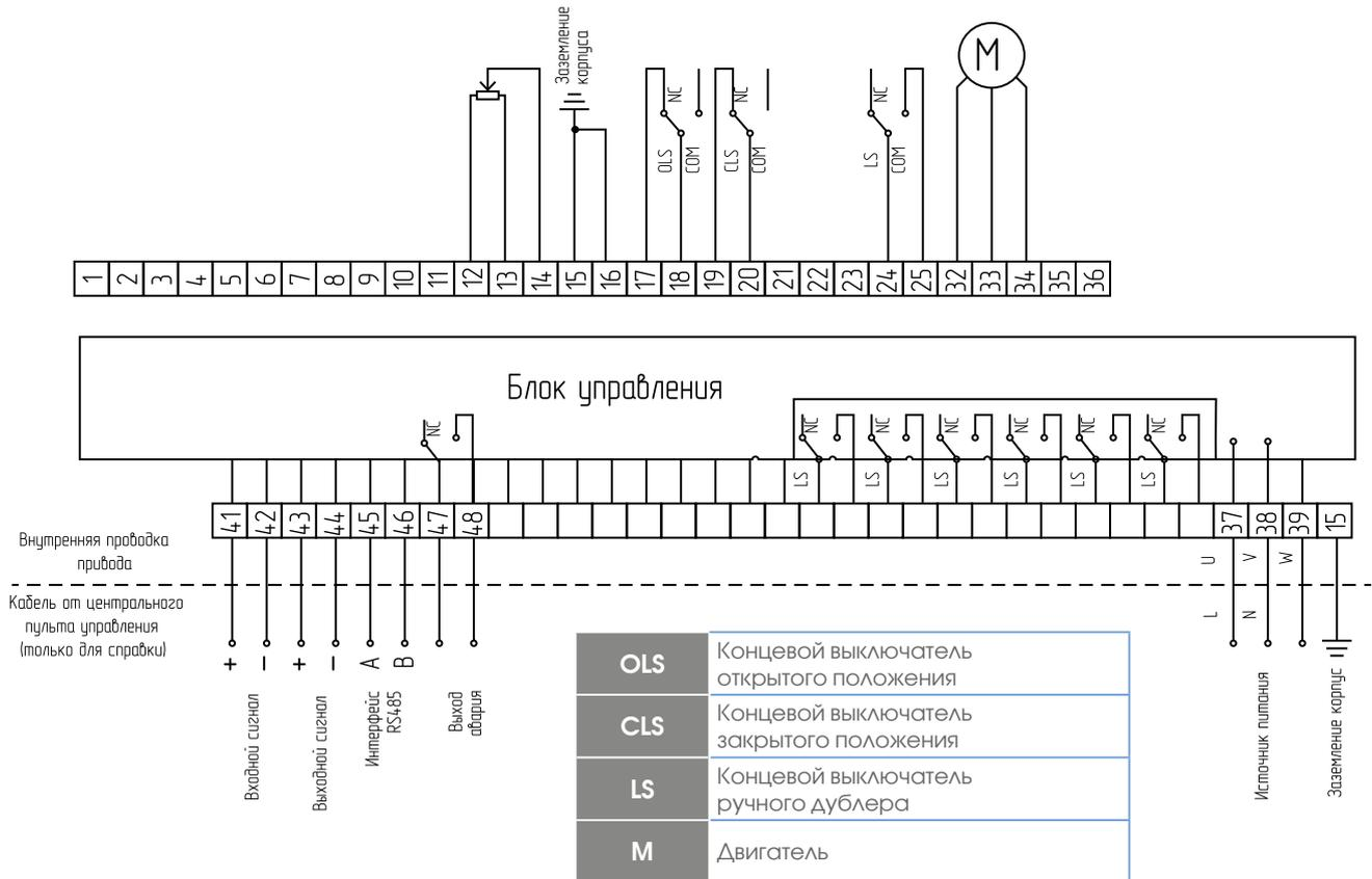
Примечание: базовая комплектация ПЭП-САЗ-1-IN имеет аналоговый входной сигнал 4-20 мА, выходной сигнал - 4-20 мА. Такие режимы, как управление сигналом 0-10 В, интеллектуальное управление переключателями, управление по цифровой шине RS485 должны быть согласованы с отделом продаж.
