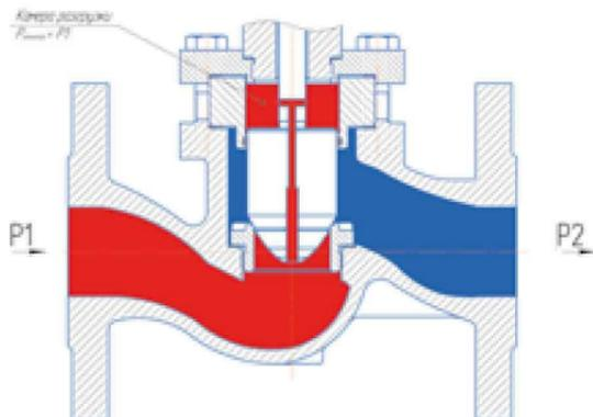
давлению седельные клапаны имеют различные по конструкции устройства, выравнивающие давление с обеих сторон затвора. Принцип действия заключается в подаче давления не только под седло клапана, по специальным каналам среда поступает сверху на седло, тем самым компенсирует давление среды снизу седла.
