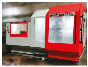
Также на площадке «Авангарда» введен в эксплуатацию многоцелевой обрабатывающий центр с ЧПУ МАНО 700 S, предназначенный для большого диапазона фрезерных, сверлильных и расточных операций на деталях средних размеров в единичном и мелкосерийном производстве. Аппарат обладает главным приводом мощностью 15кВт и помогает обрабатывать детали весом до 300 кг. Он оборудован многопозиционным инструментальным магазином на 60 инструментов.
