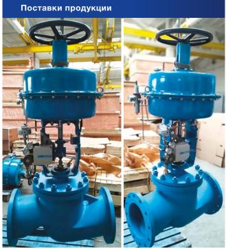
В области производственной деятельности САЗ «Авангард» выполнил поставку регулирующих односедельных клапанов 25нж52нж диаметром 250 миллиметров и давлением 1,6 МПа с мембранным исполнительным механизмом. Изделия изготовлены из нержавеющей стали, в качестве регулируемой среды – водогазонефтяная эмульсия.
