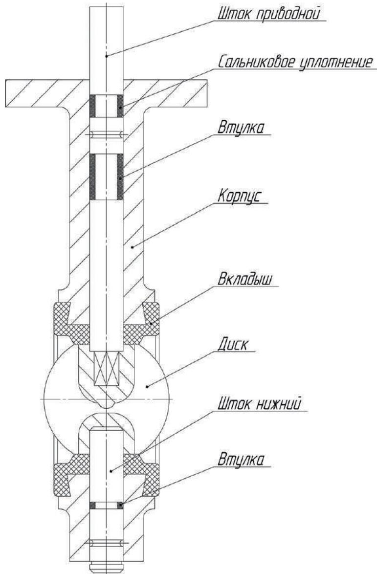
**МАТЕРИАЛ ОСНОВНЫХ ДЕТАЛЕЙ ЗАТВОРА ПОВОРОТНОГО С СИММЕТРИЧНЫМ ДИСКОМ**
