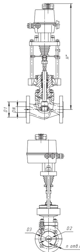
**Клапан запорный муфтовый с электрическим исполнительным механизмом DN15-50, PN1,6 МПа**
