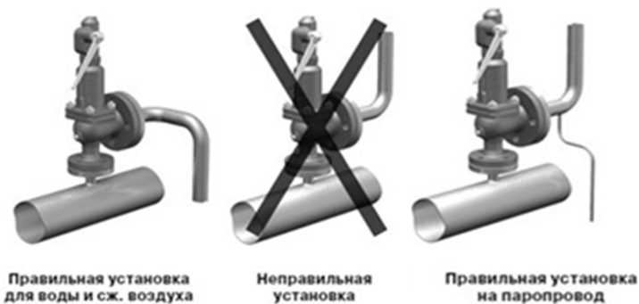
Рисунок 2. Монтаж клапана на трубопроводе
