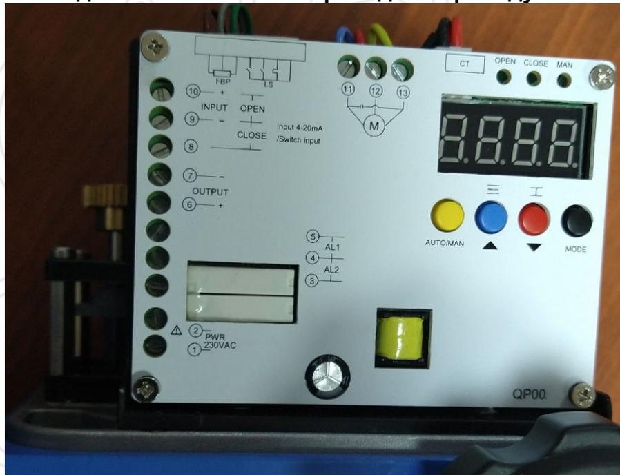
Рис. 10. Клеммы приводов на усилия 1кН и 2кН
