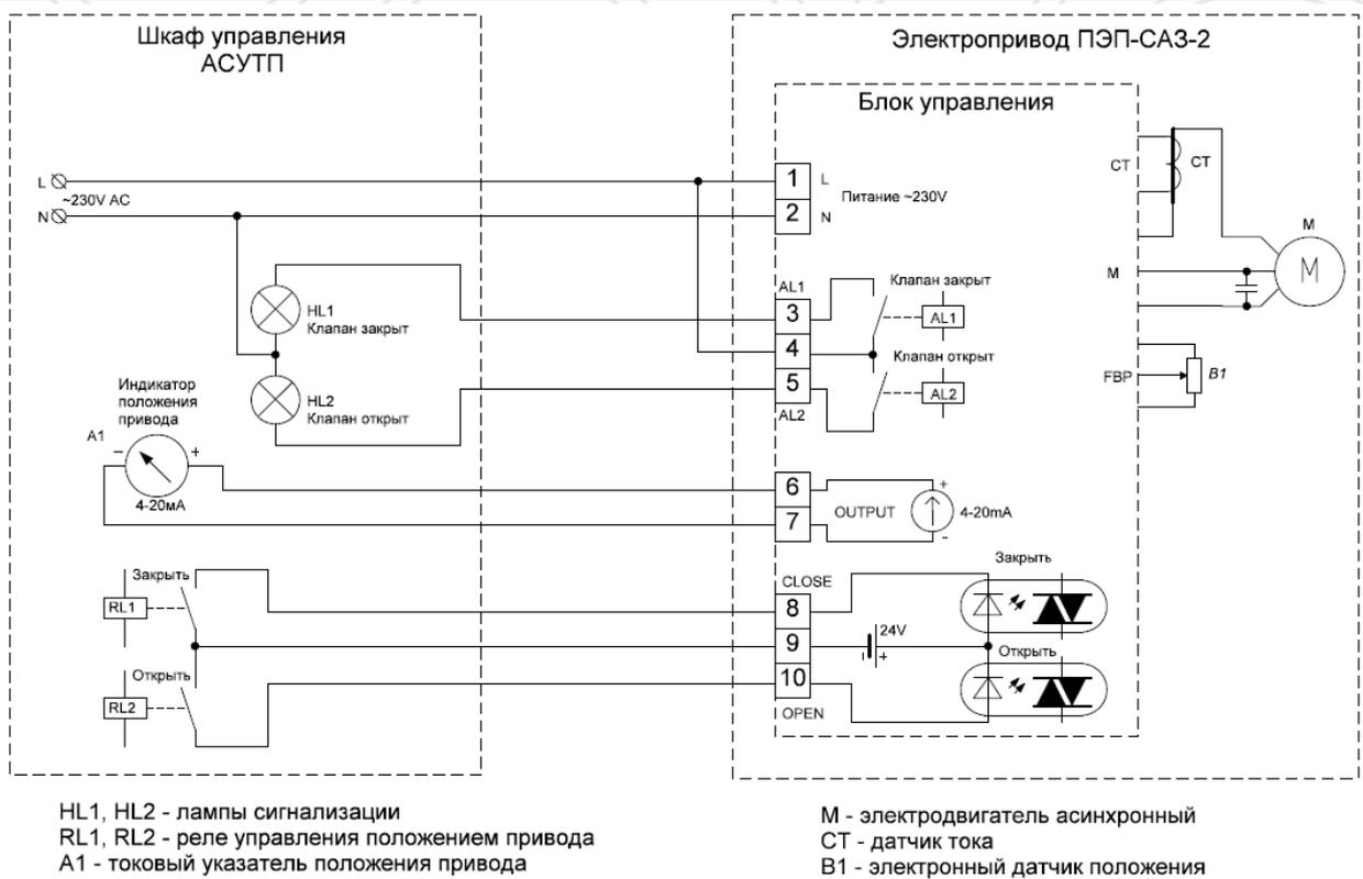
Рис. 9 Пример 3-позиционной схемы управления
