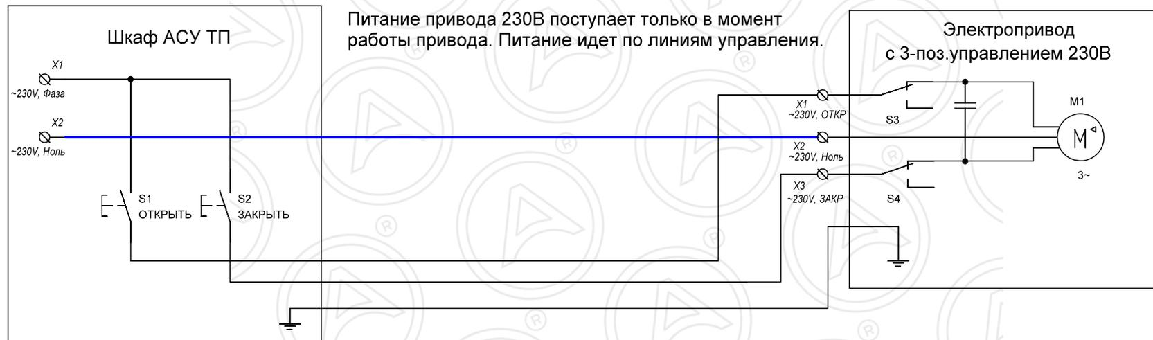
СХЕМА ЗАМЕНЫ КЛАССИЧЕСКОГО 3-ПОЗИЦИОННОГО ПРИВОДА на ПЭП-СА3-2
