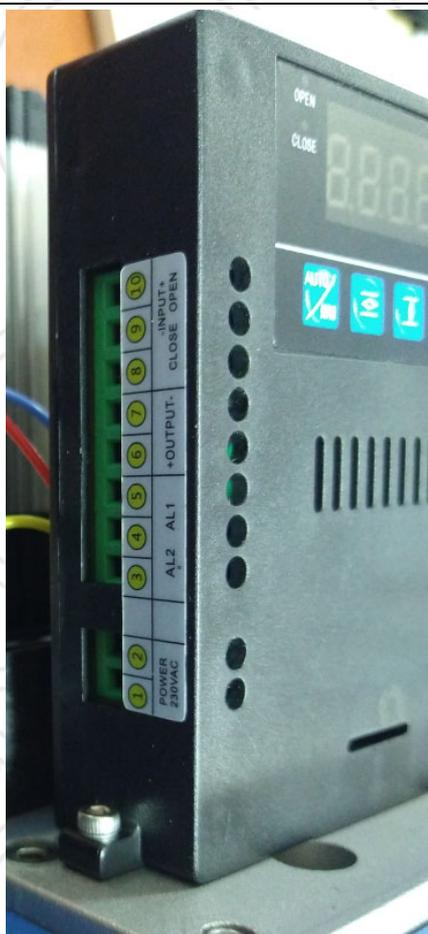
Рис. 11. Клеммы приводов на усилия 4кН ... 25кН
