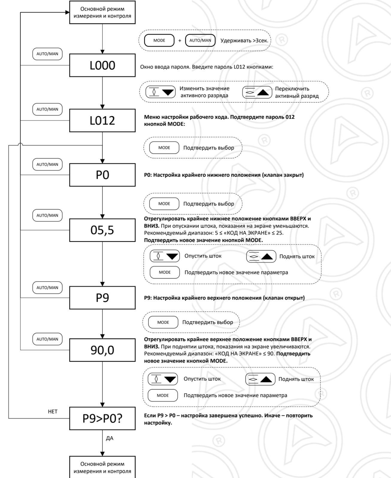
СХЕМА УПРАВЛЕНИЯ КЛАССИЧЕСКИМ 3-ПОЗИЦИОННЫМ ЭЛЕКТРОПРИВОДОМ КЛАПАНА
