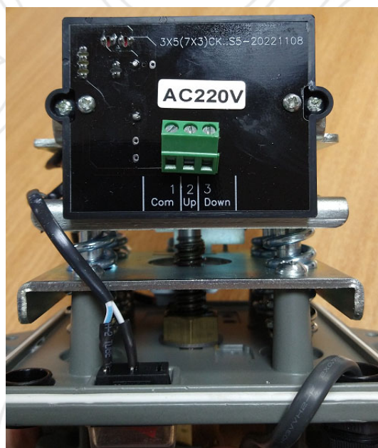
Рис.5 Клеммы подключения кабеля ПЭП-СА3-3-1500 (слева); ПЭП-СА3-3-5000 (справа)
