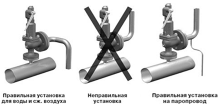
Рисунок 2. Монтаж клапана на трубопроводе
