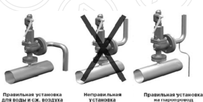
Рисунок 2. Монтаж клапана на трубопроводе
