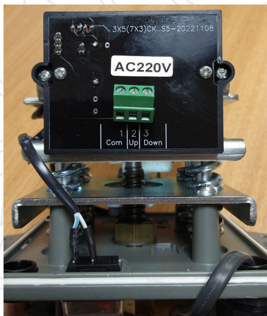
Рис.3 Клеммы подключения кабеля LY-1500 (слева); LY-5000 (справа)
