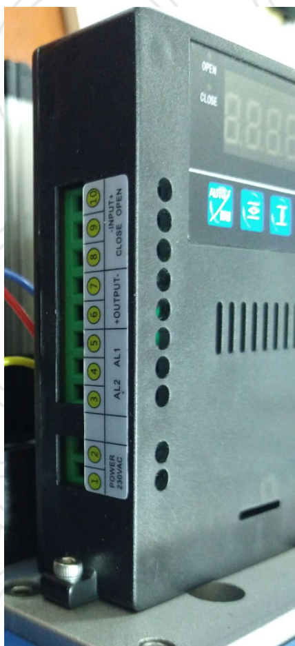
Рис. 12. Клеммы приводов на усилия 4кН ... 25кН
