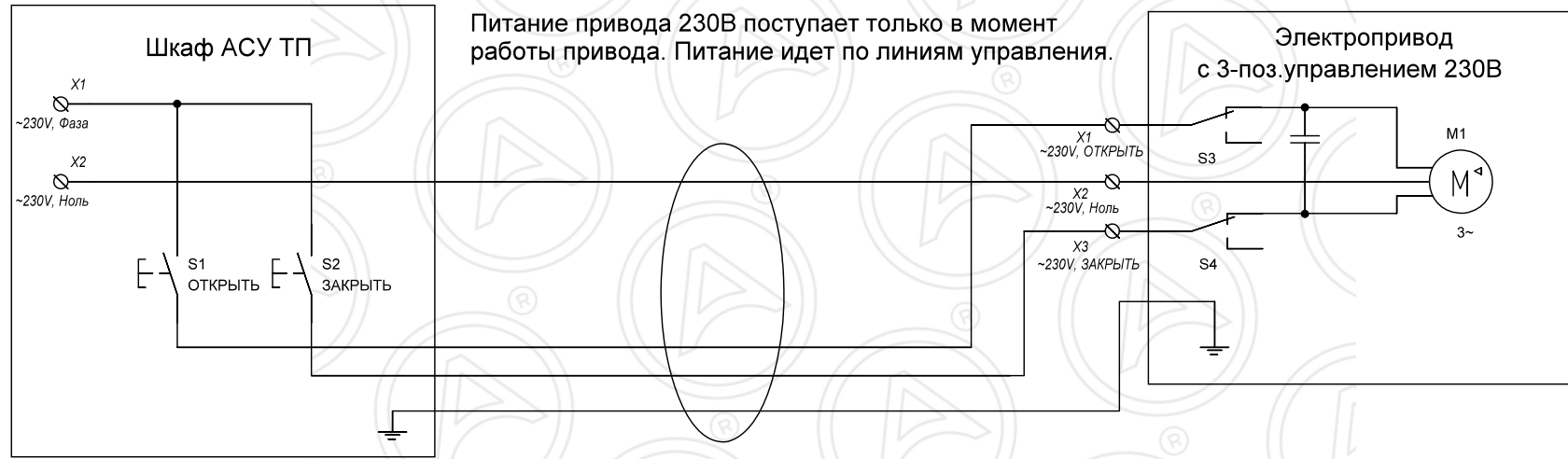
СХЕМА ЗАМЕНЫ КЛАССИЧЕСКОГО 3-ПОЗИЦИОННОГО ПРИВОДА на ПЭП-СА3-2 в режиме трехпозиционного управления
