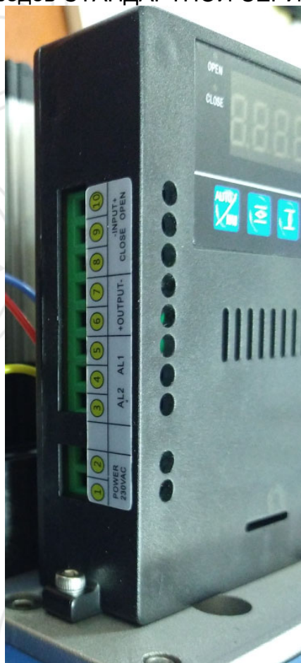
Рис. 12. Клеммы приводов СТАНДАРТНОЙ СЕРИИ на усилия 4кН ... 25кН
